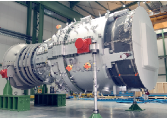
Die Siemens Gasturbine SGT5-8000H ist die derzeit größte und leistungsstärkste Gasturbine der Welt. Nach der Testphase wird die Anlage zu einem GuD-Kraftwerk erweitert, dessen Wirkungsgrad bei über 60 Prozent liegen wird.
